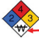
Şekil 4.1. NFPA tarafından yapılan tehlike sınıflandırılması ve açıklaması
